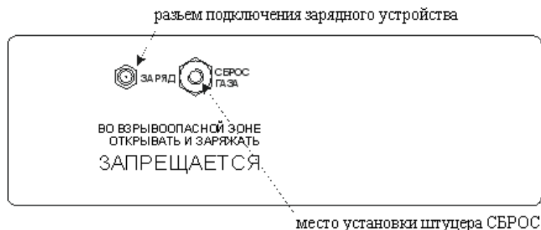
Рис. 2. Передняя (а) и задняя (б) панель газоанализатора
