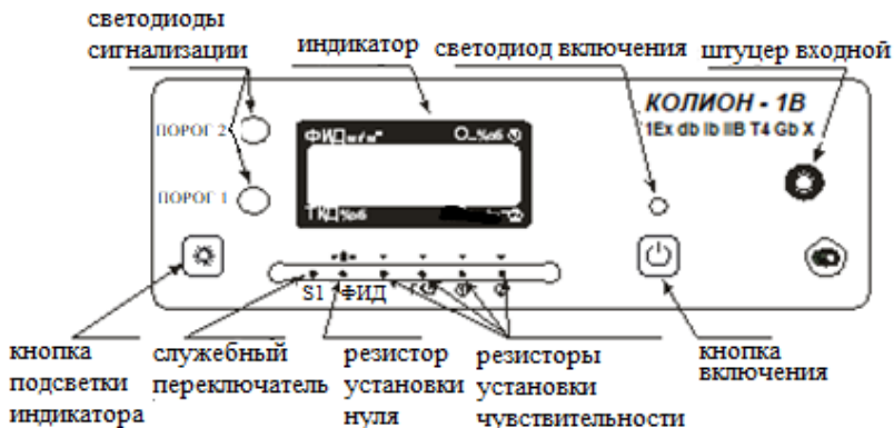
Рис. 1. Лицевая панель газоанализатора
