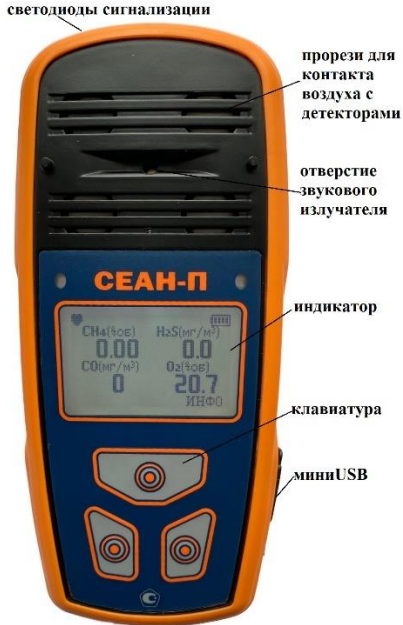
Рис. 1. Внешний вид газоанализатора
