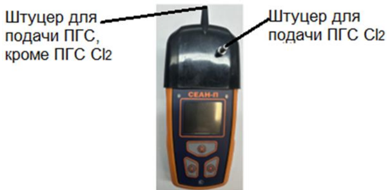
Рис. 3.1. Газоанализатор со штуцером для подачи ПГС Cl 2
